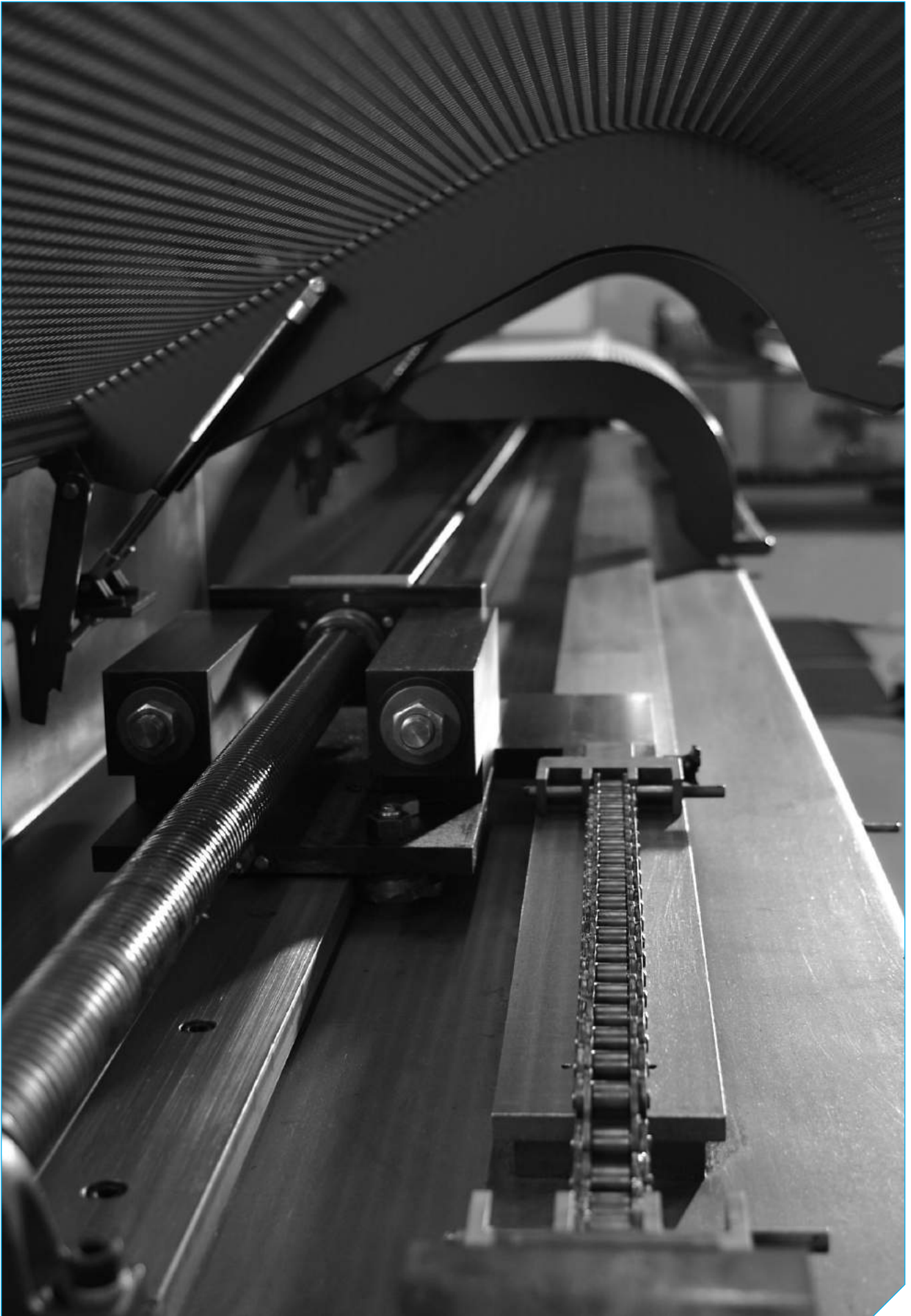
Matchy – Vorrichtung zum paarweisen Vorrecken für Parallellauf
