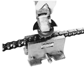
Abschleifen der Bolzenenden
