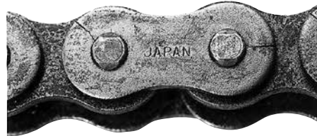
Risse durch Wasserstoffversprödung
