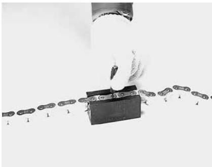
Trennen der Poly-Stahl-Kette
