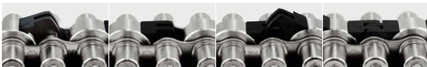
Der zweiteilige Clip wird durch einfaches Aufstecken auf die Kettenbuchse des Innengliedes montiert.
